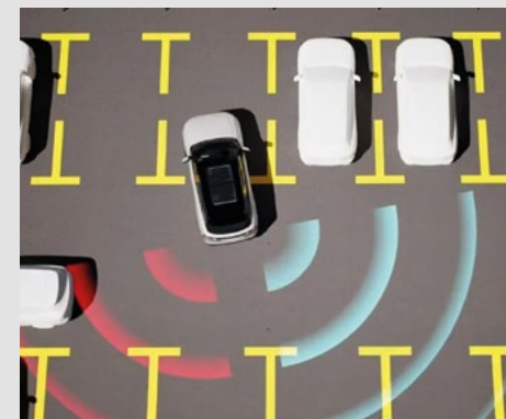
System ostrzegania przed kolizją podczas cofania (RCW)
