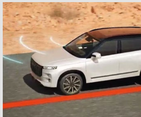
System zapobiegający niekontrolowanej zmianie pasa ruchu (LDP)
