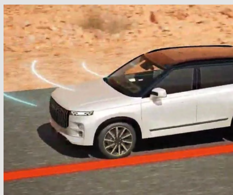
System zapobiegający niekontrolowanej zmianie pasa ruchu (LDP)
